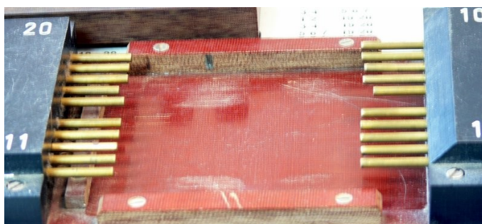
Rys. 10. Specjalizowana elektroda grzebieniowa dla złącz wielostykowych
