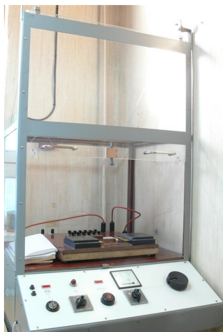
Rys. 6. Widok ogólny szafy do prób wysokonapięciowych
