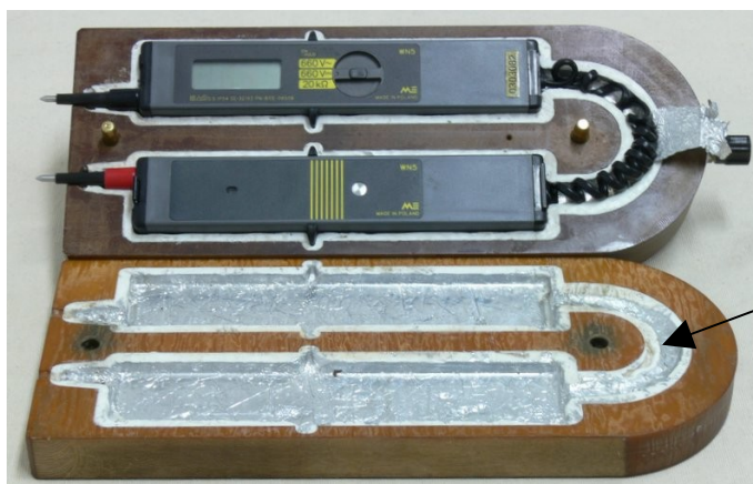
Rys. 9. Specjalizowana elektroda dotykowa dla rodziny mierników WG5 i WN5 produkcji METROL
